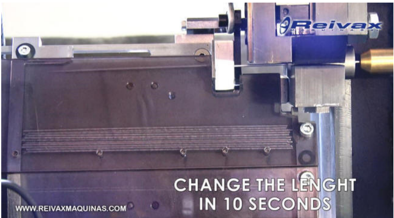
Máquina CN para enderezar y cortar tramos cortos de varilla de alambre.
